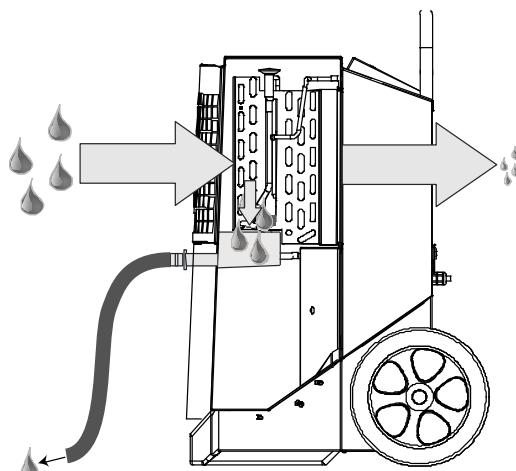
По мере того как воздух циркулирует через осушитель, его влажность постепенно снижается, что приводит к быстрому, но мягкому осушению. Осушитель может работать непрерывно или включаться и выключаться встроенным гигростатом.
