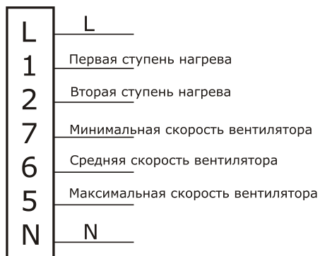
Рис. 5. Электрическая схема подключения пульта управления
