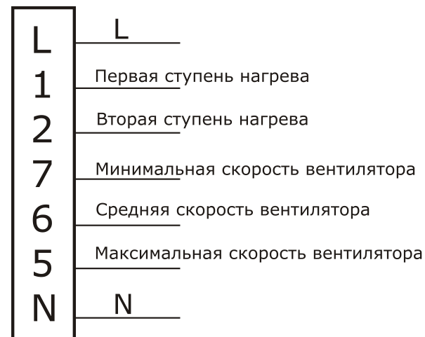
Рис. 4. Электрическая схема подключения пульта управления
